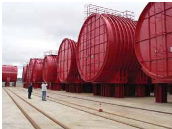
Самая надежная упаковка для реактора и его «обвязки» – это прочный корпус подводной лодки. После очистки и специальной подготовки его помещают на площадку, где он будет безопасно храниться ближайшие 70 лет. Каждые 10 лет его будут транспортировать в цех для восстановления покрытия и радиационного мониторинга. А через 70 лет решение будет принимать уже наши потомки – им разбираться, что дальше делать с остатками холодной войны.
