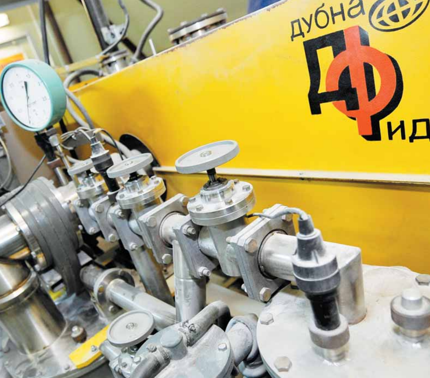
В январе во Владивостоке стартовал проект по приему ртутьсодержащих ламп и батареек от населения «Утилизируй правильно». Бытовые отходы I класса опасности утилизируют на вакуумной установке УРЛ-2м на заводе компании «ПримТехнополис». После переработки газ из ртутных ламп остается в фильтрах, стеклом используют для дорожного покрытия, цоколи отправляют в металлолом, а ртуть – в промышленное использование. Фото: Юрий Смитюк/ТАСС
