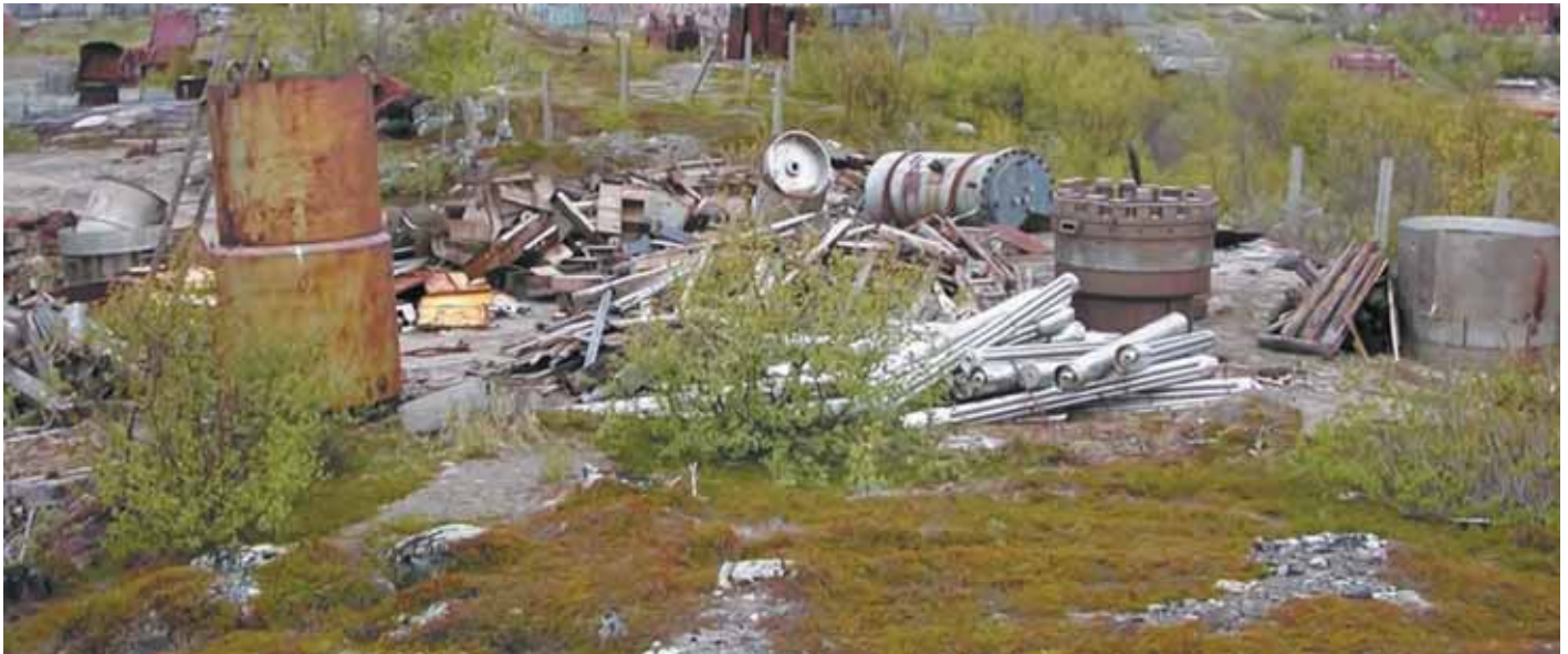
На площадке № 3 в губе Андреева складировалось также загрязненное оборудование, демонтированное из реакторных отсеков АПЛ при различных операциях техобслуживания. На переднем плане – чехлы из-под ОТВС. Слева – металлические бочки, в которые загружали радиоактивный мусор. На грунт были слиты десятки тысяч литров радиоактивной воды. Окружающая территория загрязнялась стоками, ветер разносил вокруг радиоактивную пыль. Сегодня благодаря международным усилиям ТРО с открытых площадок в губе Андреева убраны, радиационный фон существенно улучшен. Фото из архива «Беллоны»
