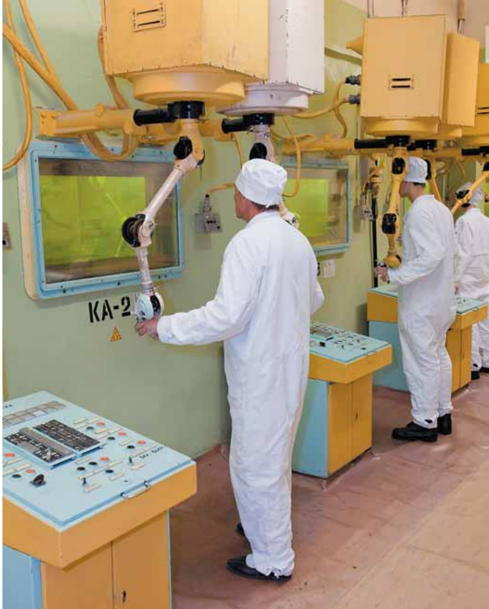
Операторы во время работы с помощью манипулятора у окна из оцинкованного стекла, защищающего от активных элементов, в отделе по работе с плутонием на ПО «Маяк». Россия, Челябинская область. Фото: Илья Яковлев/ИТАР-ТАСС
