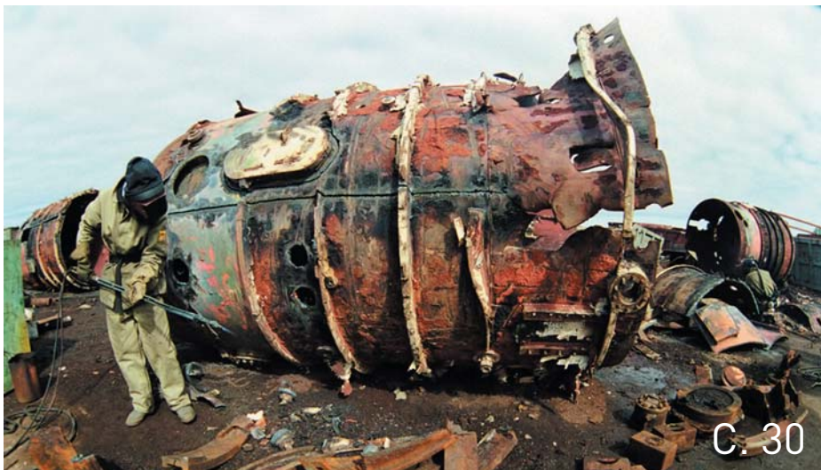
Сварщик в защитном костюме разрезает детали корпуса атомной подводной лодки на предприятии «Звездочка». Россия, Северодвинск, Архангельская область.
