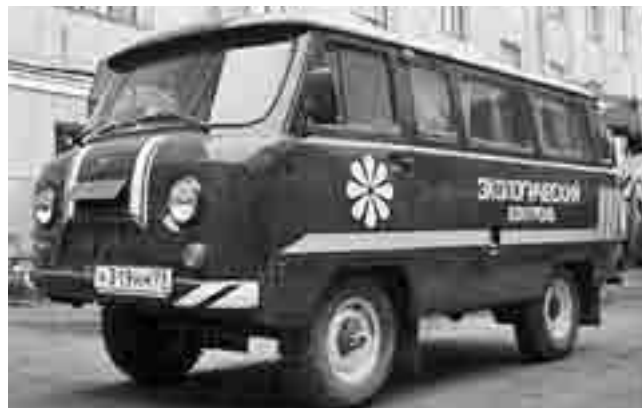
Передвижная станция контроля качества воздуха
