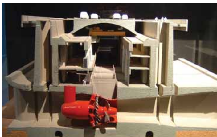
Масштабная модель поперечного сечения машинного зала.
